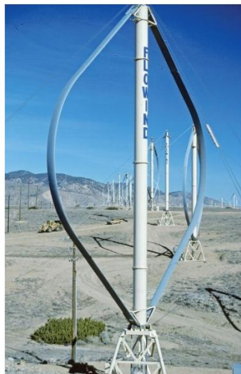
Figura 11 - rotor – \Phi , da flowind company. TEV com maior sucesso no mercado [7]
