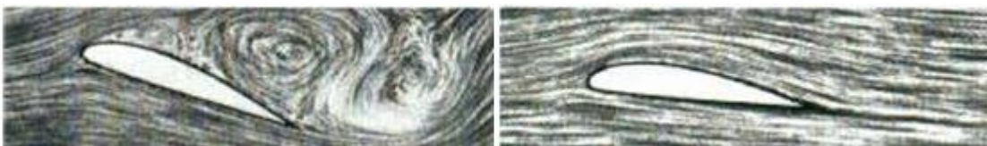
Figura 18 – Fluxo turbulento por conta do controle estol e o fluxo laminar, respectivamente [6].
